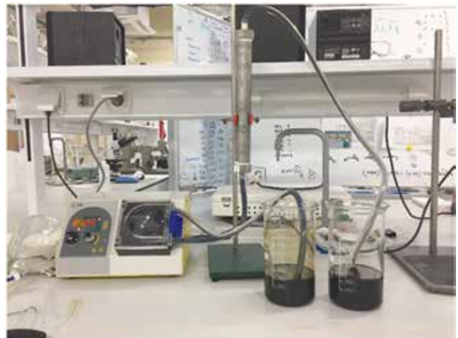
Рисунок 6 – Лабораторная установка для испытаний олеофильных (OF) полимерных матриц Figure 6 – Laboratory equipment for testing the oleophilic polymer matrix
