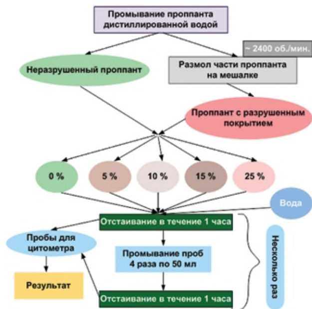
Рисунок 9 – Блок-схема этапов проведения эксперимента Figure 9 – Block diagram of the stages of the experiment
