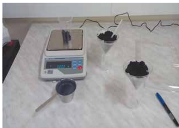
Рисунок 10 – Получение навесок образцов проппанта Figure 10 – GEOSPLIT proppant samples preparation
