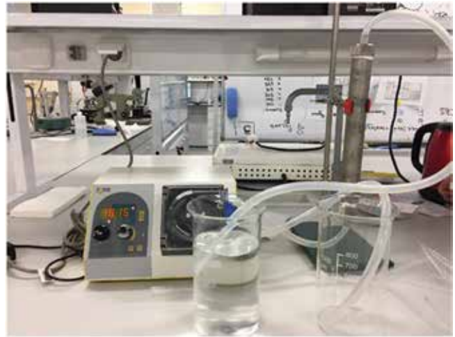
Рисунок 5 – Лабораторная установка для испытаний гидрофильных (HF) полимерных матриц Figure 5 – Laboratory unit for testing the hydrophilic polymer matrix
